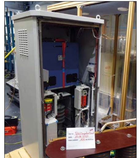
Bild 8: Blitzstrom-Festigkeitsprüfung mit 100 kA (10/350 \mu s)
