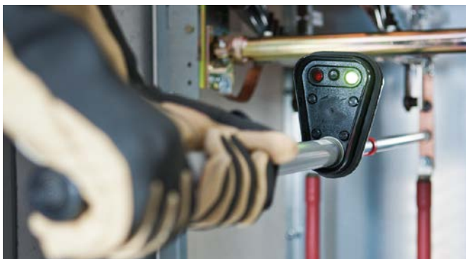
Spannungsprüfer PHE mit optischer Anzeige.
