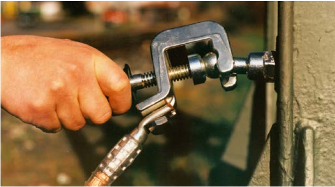
Universalerdungsklemme mit Handgriff auf einem Kugelfestpunkt.
