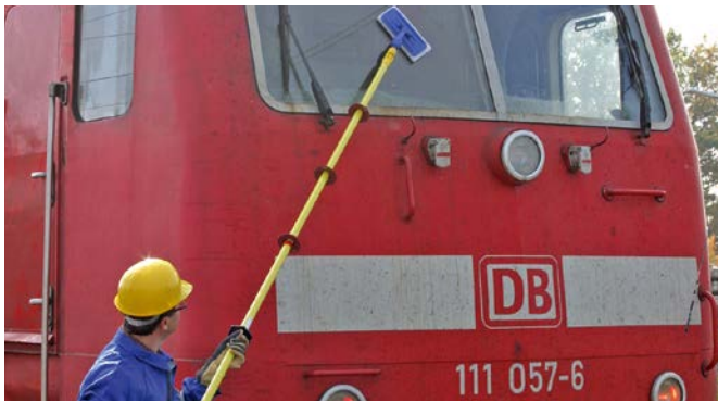
Scheibenreinigung einer E-Lokomotive mit dem Isolierstangen-Set.
