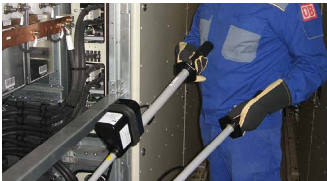
Gleichspannungsprüfer PHE/G II für Gleichstromzwischenkreise (ICE-Triebkopf).
