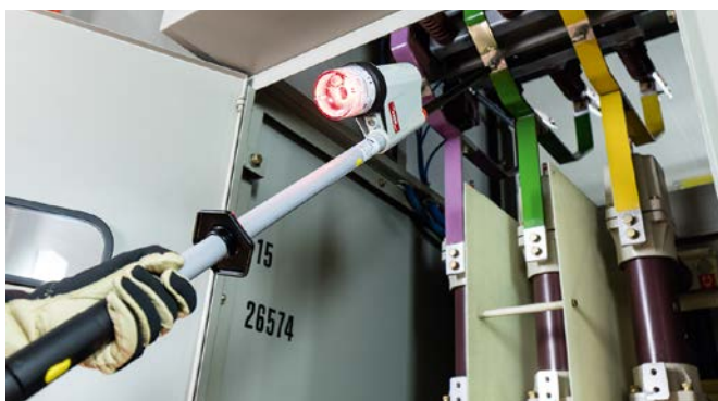
Spannungsprüfer PHE4 mit optischer und akustischer Anzeige.
