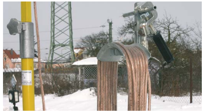
Erdungsspieß mit aufgewickelter Erdungsleitung.
