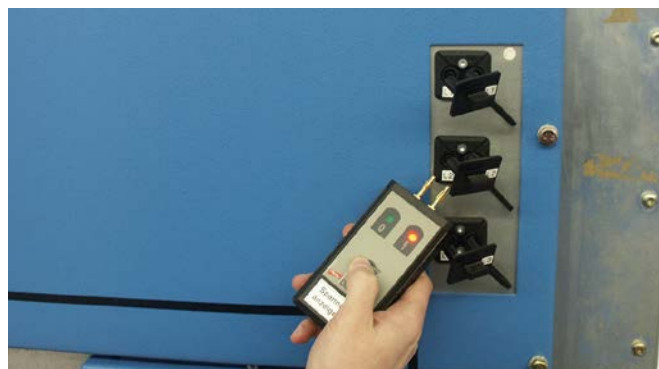
Eigenprüfung des Spannungsanzeigerätes DEHNcap/A.
