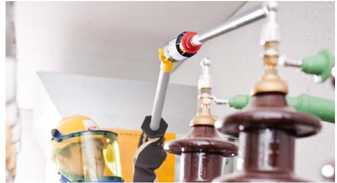
Prüfkopf PHE III mit Universalzahnkupplung und Isolierstange.
