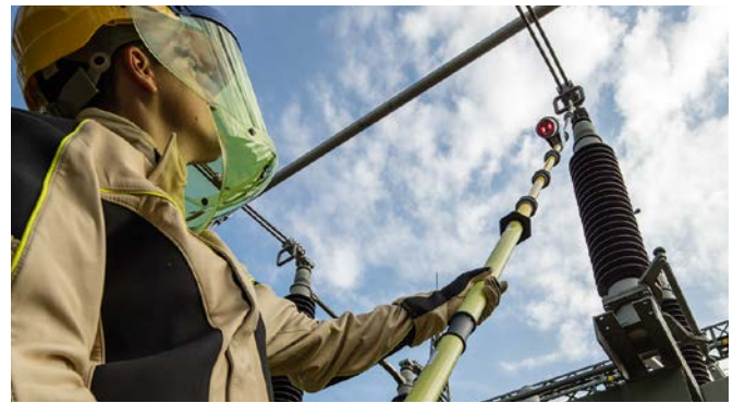
Spannungsprüfer PHE4 an einer Freiluftstation 110 kV.
