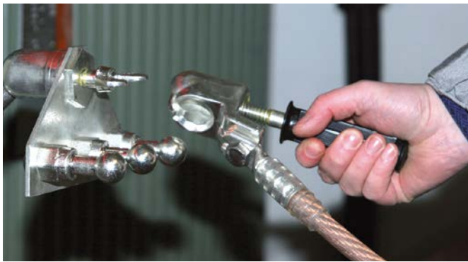
Erdanschlussplatte mit Kugelfestpunkten und Kugelkopfhaube mit Handgriff aus Kunststoff.
